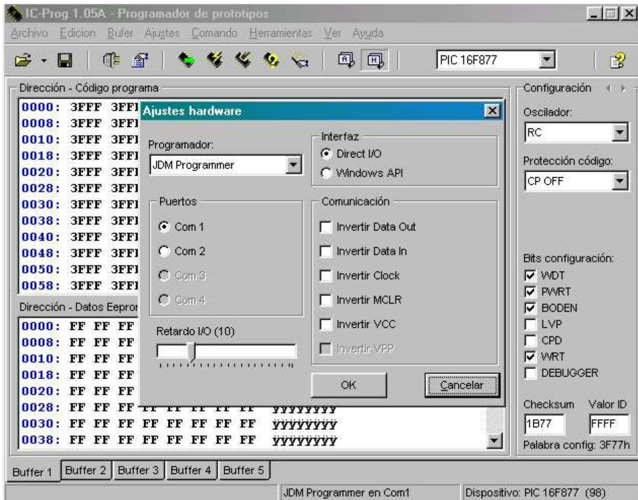
Al momento de finalizar la configuración del programa el led incluido debe estar apagado. Dentro del menú ajustes, hay una opción para comprobar el funcionamiento del programador.
