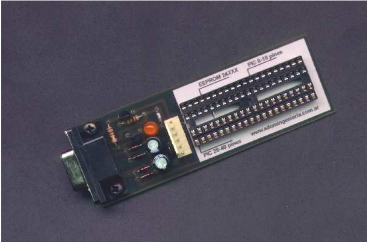
Dispone de un zócalo especialmente configurado que permite conectar, tal como se ve en el diagrama, diversos tipos de PIC's, y memorias EEPROM seriales y un zócalo para su utilización como PROGRAMADOR IN-CIRCUIT.
